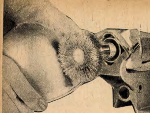
Durva előcsiszolás villamos kézfűróba fogott drótkéfével
